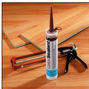
Les mastics acryliques COLORSEALANT sont adaptés à la réalisation de joints colorés et sont étanches à l'eau. Ils sont utilisés en périphérie des revêtements de sols stratifiés lorsque la mise en œuvre de plinthe ou de couvre-joint est impossible.
